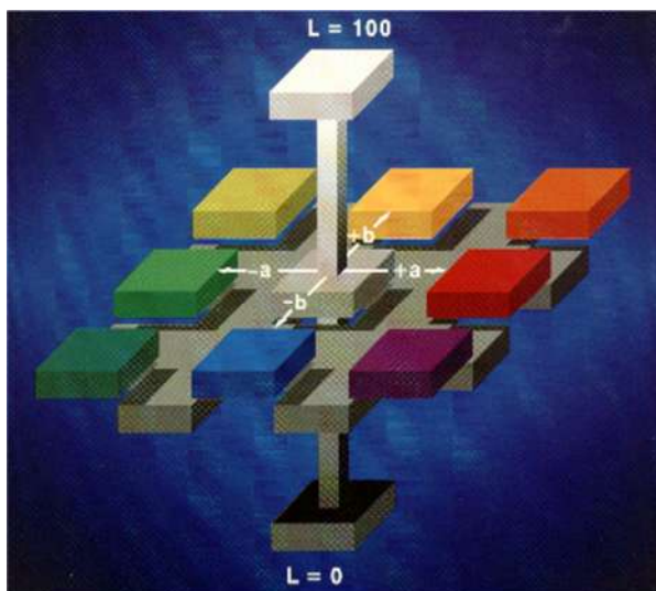
FIGURA 2. Representação do sistema de coordenadas de Hunter.
